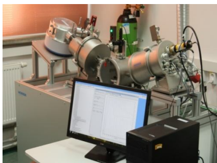
Rys.1 Skanujący spektroskopowy elipsometr z modulacją fazy UVISEL VUV Horiba Jobin-Yvon.
