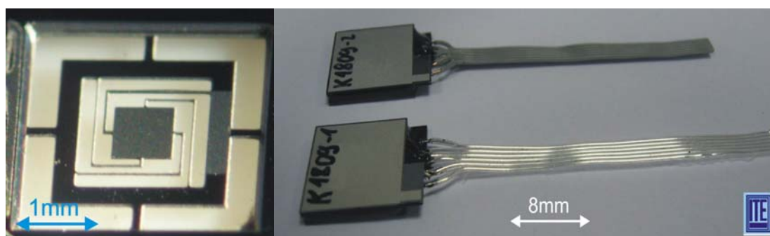
Rys.1. Przykłady różnego typu struktur krzemowych przetworników mikromechanicznych opracowanych i wykonanych w ITE.
