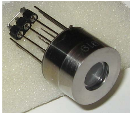
Rys. 11. Fotodetektor InGaAs/InAlAs/InP z wnęką rezonansową zamontowany na chłodziarce Peltiera
