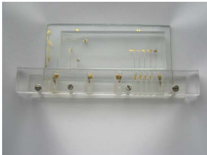
Rys.6. Chip elektroforetyczny trzeciej i czwartej generacji. Z lewej widoczny chip umieszczony w slotcie z wyprowadzeniami elektrycznymi.
