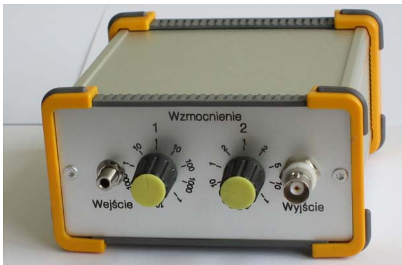
Rysunek 2. Wykonany interfejs optoelektroniczny z dwupunktową regulacją wzmocnienia
