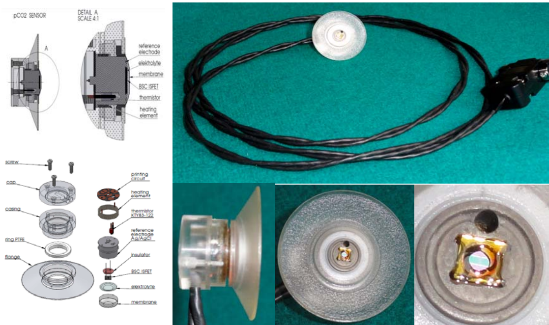
Rys.4 Model i elementy konstrukcyjne oraz fotografia naskórnego czujnika do pomiarów pCO_2 w krwi tętniczej
