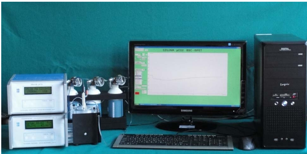
Rys. 7 Stanowisko do testowania i kalibracji czujników do gazometrii krwi.
