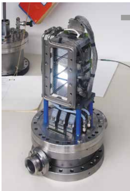
System detekcyjny do analizy pierwiastków superciężkich, którego sercem są detektory opracowane w ITE
